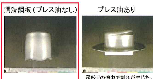
「潤滑鋼板」(写真左)は、プレス油がなくても、金型とポンチの間を鋼板がスムーズに滑るため、複雑な形状であっても割れずに成形できる。プレス油を使った通常の鋼板(写真右)を上回る成形性を実現。
