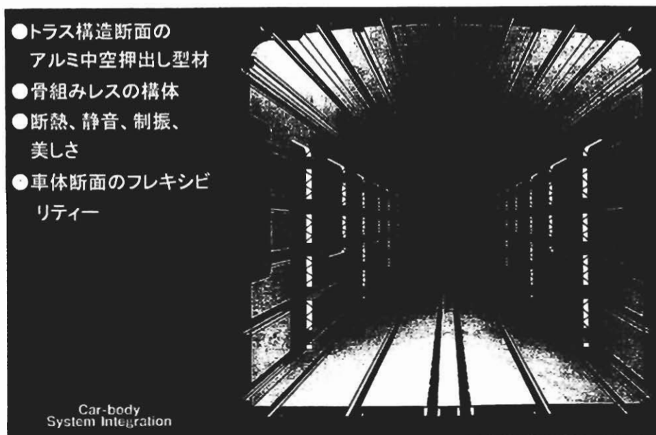
図16 ダブルスキン構体の部材構成
