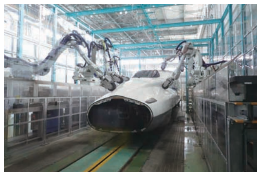
JR 東海殿 新幹線先頭研ぎ装置
