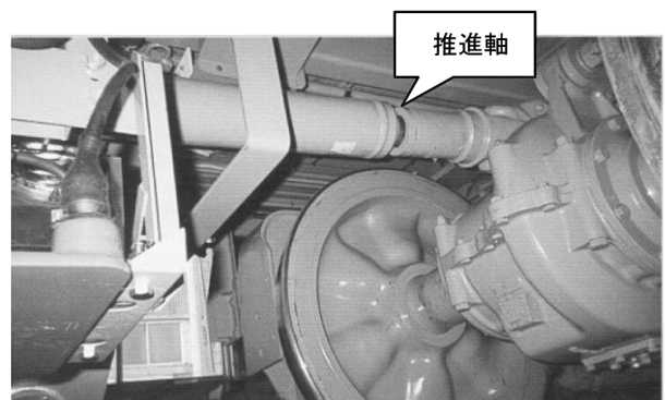
写真1 推進軸の取付け状態
