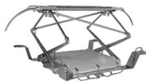
図12 従来の下枠交差形パンタグラフ
