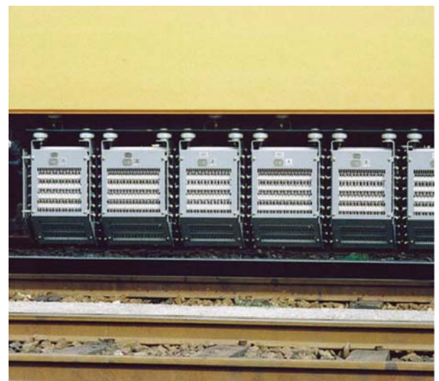
車体に取り付けた車両用抵抗器
